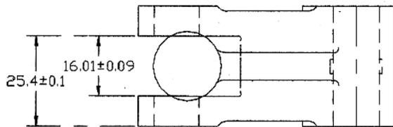
Fig. 4. roller gap milling
